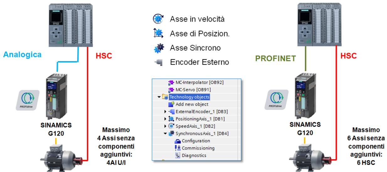
Si sottolinea che rispetto alla soluzione S7-300, l'S7-1500 supporta il posizionamento in anello chiuso e non marcia veloce/lenta e consente di eseguire il Gearing Relativo con il Setpoint del master.
