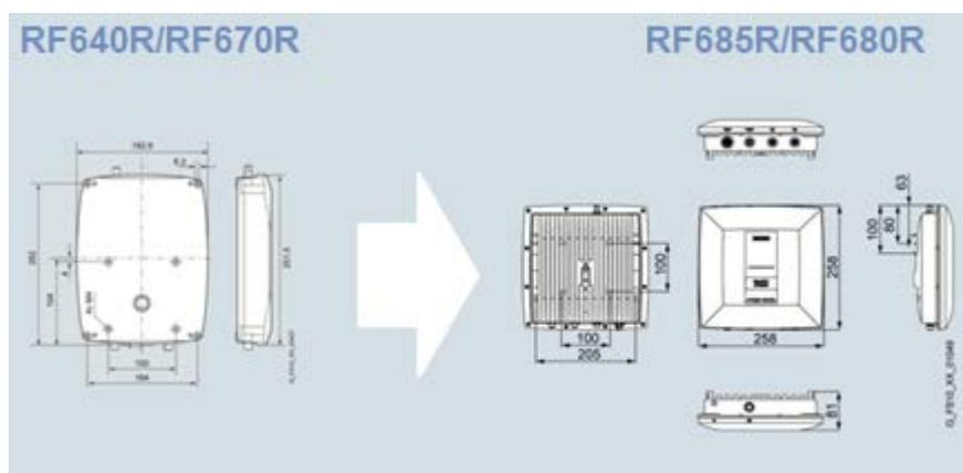
2. Il connettore Ethernet dei reader RF640R/RF670R (RJ45 Push-Pull) deve essere sostituito con il connettore M12/4-pin (RF685R e RF680R, articolo No.: 6GK1901-0DB20-6AA0 ).
